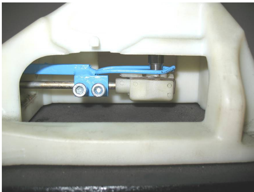
Рисунок 12. Подгибание усиков блокирующего элемента
